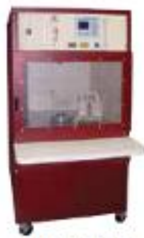
AC, 100 kV, ASTM D149
